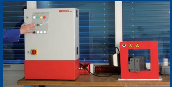
Die Bedienung erfolgt in sicherem Abstand zur Spule um eine unzulässige Feldexposition zu vermeiden.
