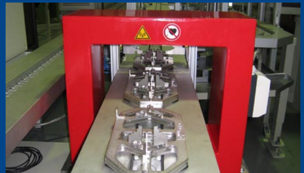
Pulsauslösung durch optionale Lichtschranke in einem automatisierten Produktionsablauf.
