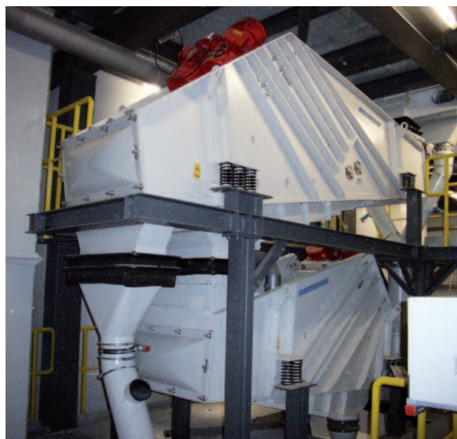
Linear Vibratory Screens LE 1024 and LE 1037
