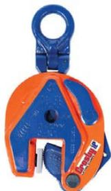
IPU10 垂直起重钳可以根据需要，以从水平到垂直和下降到水平面 (180°) 的方式升降、转向、移动或垂直移送产品、板材或物料。通过铰链吊环，夹具可从任何方向或使用没有侧负荷夹具的多支架吊索来放置和起重负荷。
